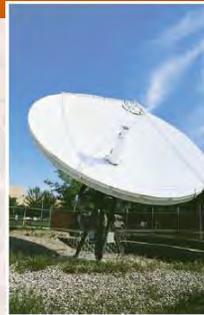
Sebuah piringan satelit yang memantulkan sinyal pada titik fokus dari paraboloid
