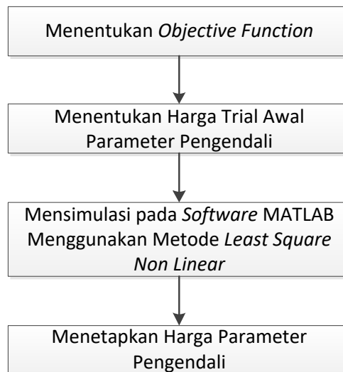
Gambar 3. Skema penyetelan dengan metode optimasi
