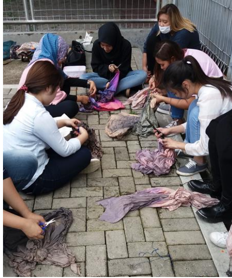
Gambar 13: Proses pembukaan ikatan dan jelujuran. (dokumentasi penulis)
