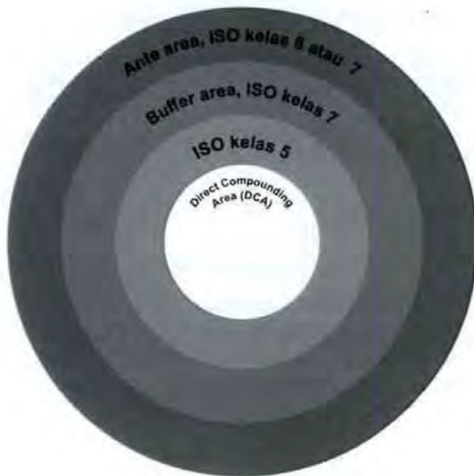
Gambar 1: Desain ruangan pencampuran produk steril dengan tingkatan risiko rendah (1), sedang, tinggi
