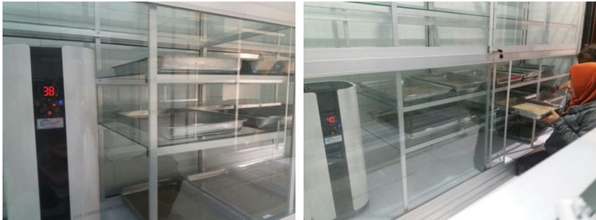
Gambar 2. Pemrosesan madu untuk menurunkan kadar air dengan sistem dehumidifikasi
