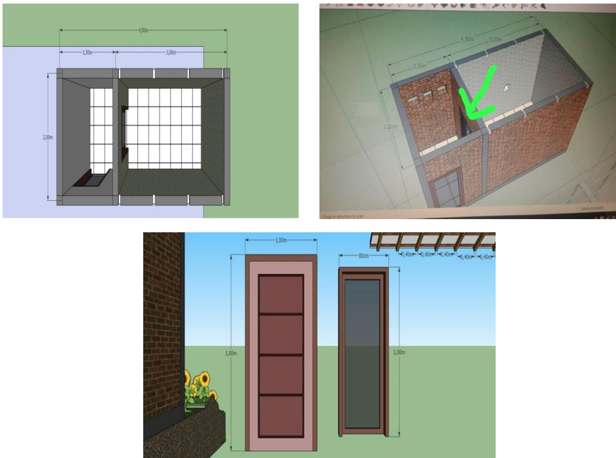
Gambar 1. Denah ruang terkontrol sistem dehumidifikasi
