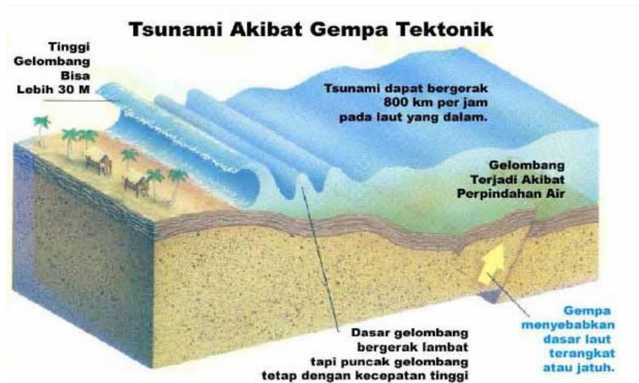
Gambar 18. Gempa yang Terjadi di Lautan Menimbulkan Tsunami (Sumber : atmago.com)
