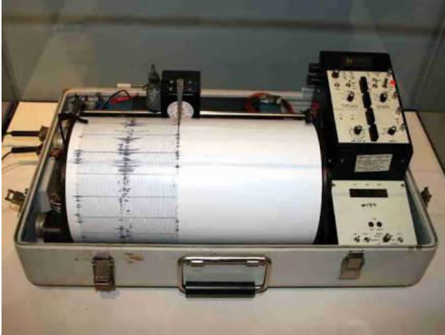
Gambar 26. Alat Pencatat Magnitude Gempa Seismograf (Sumber : pinterpandai.com)
