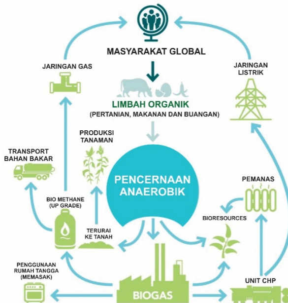
Gambar 1. Diagram pembentukan dan pemanfaatan bio gas dari limbah organik (limbah pertanian, makanan dan air buangan rumah tangga)
