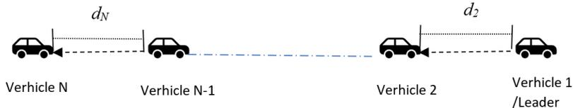
Gambar 4. Struktur kendaraan dalam formasi peleton
