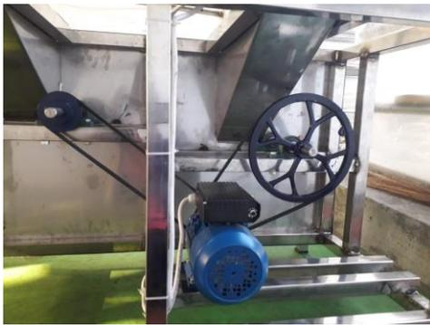
Gambar 1. Mesin perajang dan potong untuk membuat teh Ashitaba
