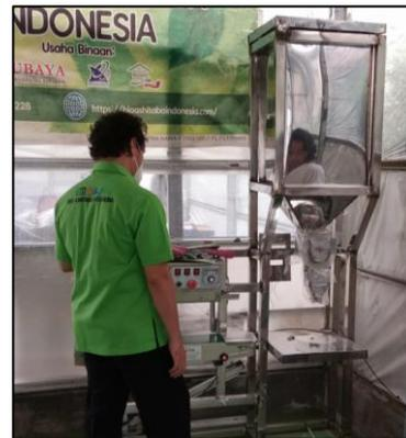
Gambar 2. Mesin filling Ashitaba untuk membuat teh stand pouch Ashitaba
