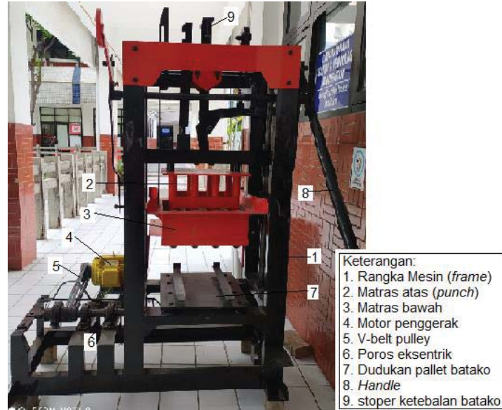
Gambar 2. Hasil Pembuatan Mesin Cetak Batako
