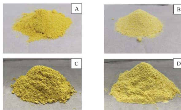
Fig. 1: Powder characteristics of (A) SSD 1:2:0.5 (B) SSD 1:4:0.5 (C) PM 1:2:0.5 (D) PM 1:4:0.5
