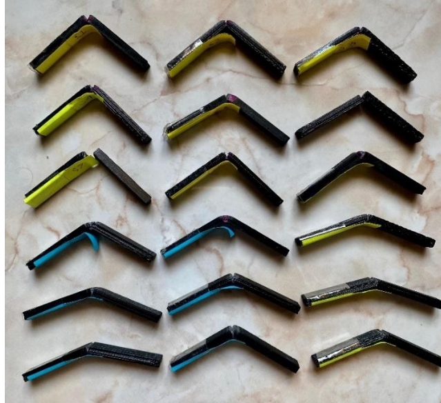
Gambar 2. Spesimen Uji Setelah Ditekuk
