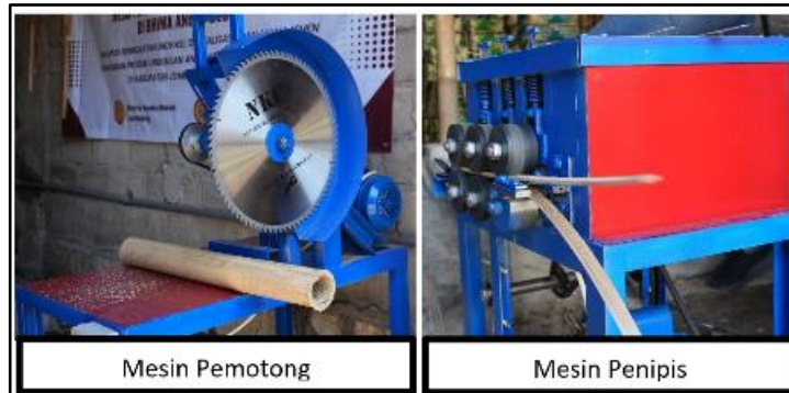
Gambar 5. Peningkatan Aset melalui Pemberian Mesin Potong dan Mesin Penipis Bambu
