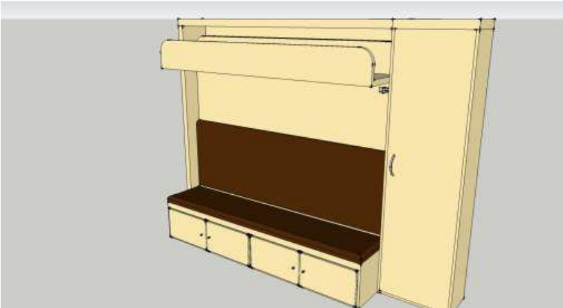
Gambar 4.40 Tempat tidur yang ergonomis menggunakan material kayu dengan mekanisme engsel dan model lemari rak (kondisi sebagai tempat duduk)
