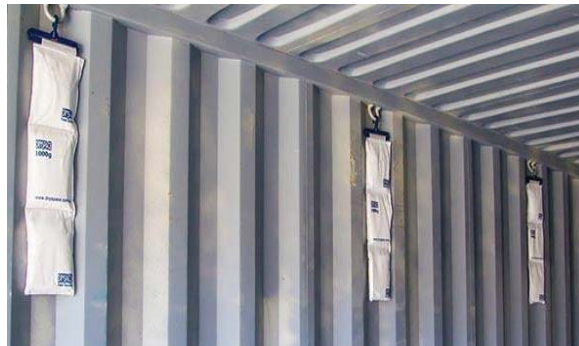
Gambar 9.15 Ilustrasi pemasangan silica gel di dinding kontainer
