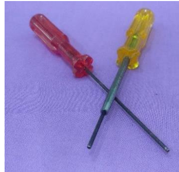
Gambar 5.21 Obeng Bulat Kecil untuk Membuka Mur Jarum
