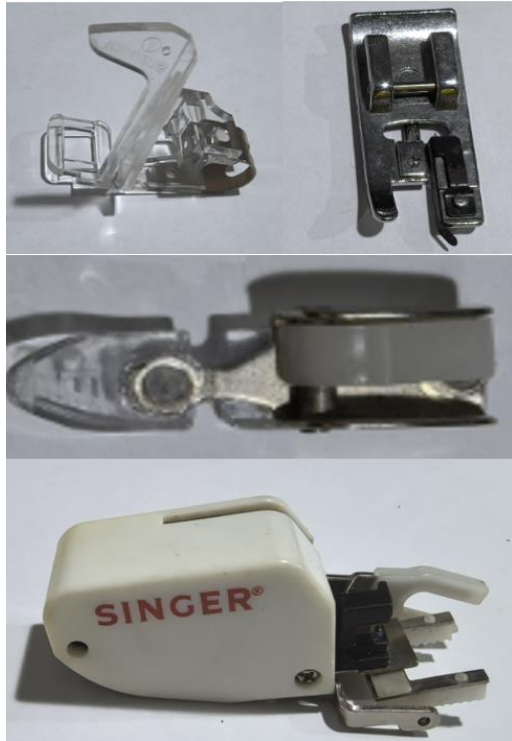
Gambar 2.18 Sepatu Variasi untuk Mesin Jahit Portable
