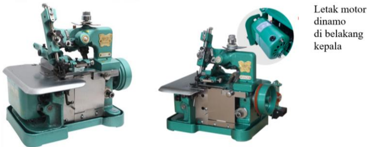
Gambar 5.1 Mesin Obras Industri Benang 3 Kecepatan Sedang Sumber: Butterfly (n.d.)
