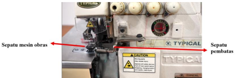
Gambar 5.25 Letak Seputi Mesin Obras dan Seputi Pembatas Tepi Obrasan
