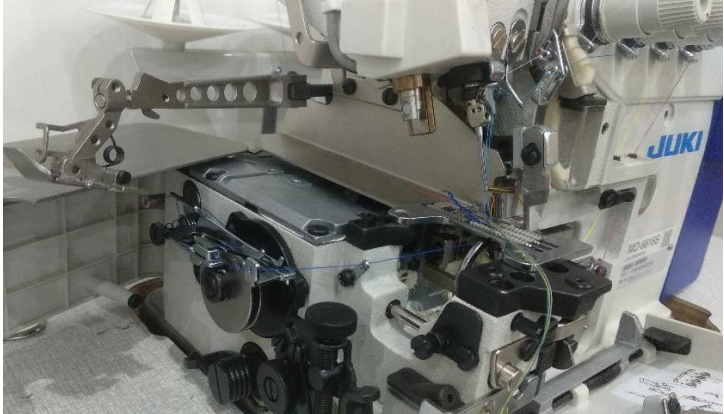
Gambar 5.11 Alur Benang 1 pada Sisi Kiri (Jarum Bawah) Mesin Obras Benang 5
