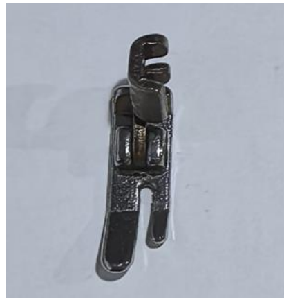
Gambar 2.6 Sepatu Jahit Biasa untuk Mesin Jahit Hitam
