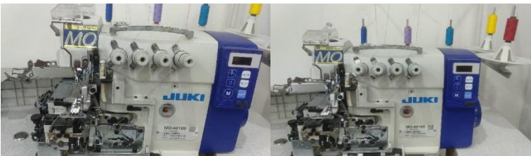
Gambar 5.10 Pemasangan Benang sesuai Petunjuk Pemasangan Benang
