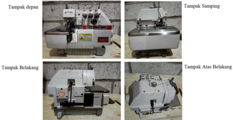
Gambar 5.2 Kepala Mesin Obras Benang 3 ( Overlock Highspeed ) Sumber: BENHO INDONESIA (n.d.)
