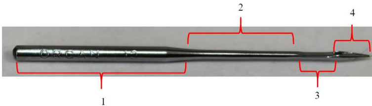
Gambar 2.31 Penampakan Jarum Mesin untuk Mesin Jahit High Speed Saat di Perbesar
