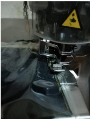
Gambar 5.2 Kepala Mesin Obras Benang 3 ( Overlock Highspeed ) Sumber: BENHO INDONESIA (n.d.)
