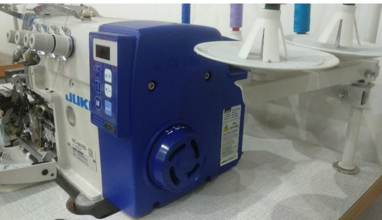
Gambar 5.15 Sisi Kanan Mesin Terdapat Dinamo Mesin Dilengkapi Digital
