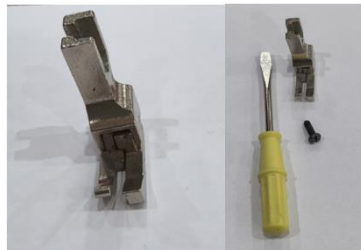
Gambar 2.27 Sepatu Biasa untuk Mesin Jahit High Speed dan Mur
