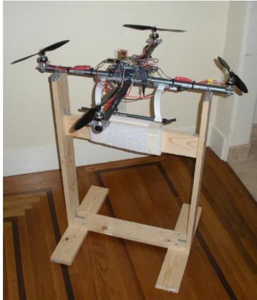
Gambar 8. Tempat Pengujian *QuadCopter* [4]
